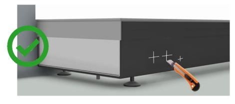
Die Aussparungen werden mit einem Messerschnitt (kreuzförmig) auf der Isolation markiert.
