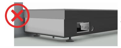
Bei Ausführung von Bodenwannen mit Trittschallisolation werden die Aussparungen (PWW, Elektro etc.) nicht komplett ausgeschnitten.
