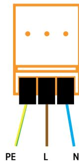
Auf der Seite des hydraulischen Anschlusses befindet sich auch die Klemmleiste für den elektrischen Anschluss. Der elektrische Anschluss wird an den orangefarbenen Klemmanschluss an der Unterseite der Abdeckplatte angeschlossen.
