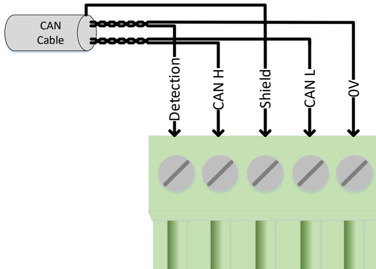
Abbildung 6: CAN-Steckerbelegung
