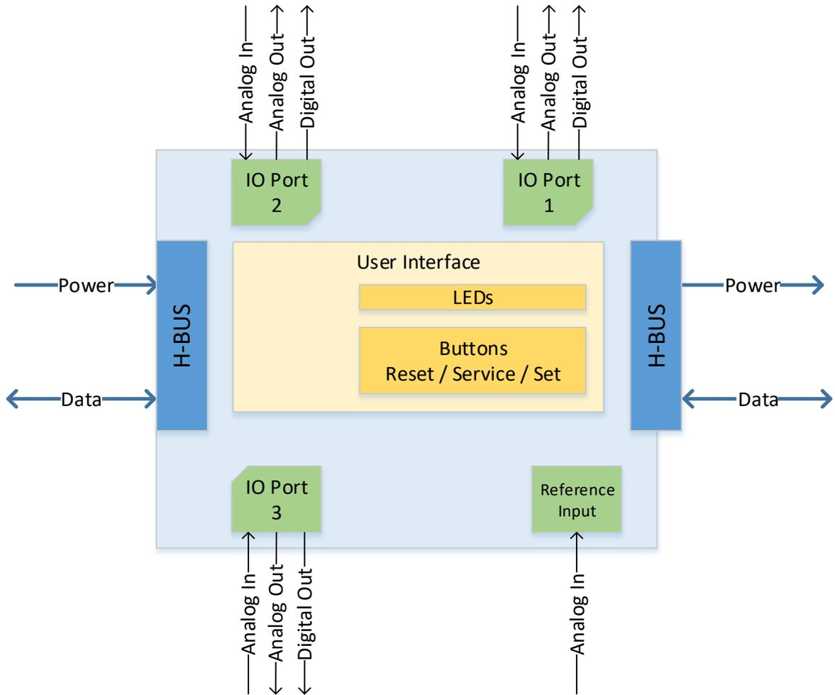
Abbildung 37: M2S I/O-Modul Blockdiagramm
