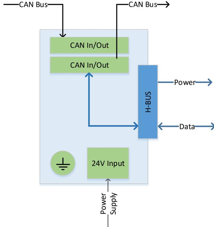
Abbildung 5: M2S Repeater-/Einspeise-Modul Blockdiagramm
