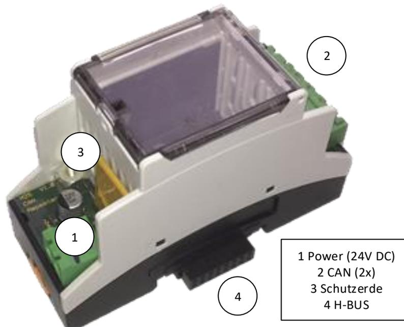
Abbildung 4: M2S Repeater-/Einspeise-Modul
