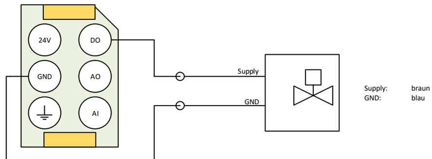
Abbildung 44: M2S I/O-Modul Anschlussbeispiel Ventil (Ein / Aus)
