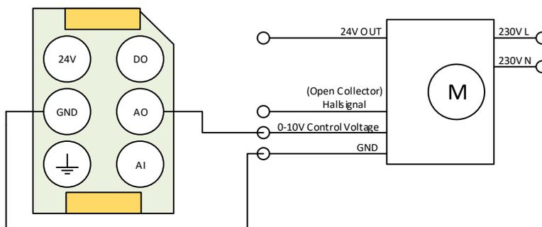
Abbildung 41: M2S I/O-Modul Anschlussbeispiel Ventilator mit externem Steuergerät
