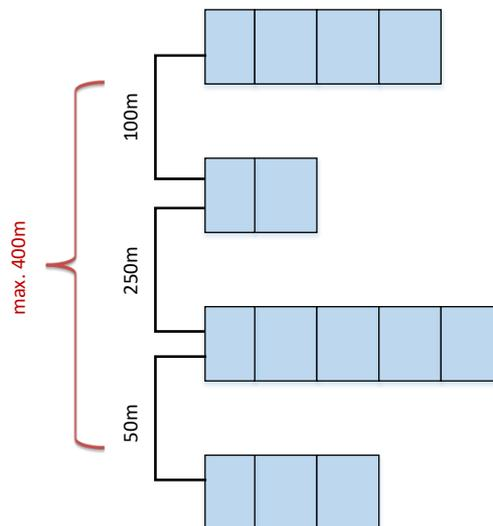
Abbildung 7: CAN-Leitungslängen Beispiel
