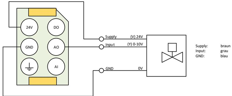
Abbildung 43: M2S I/O-Modul Anschlussbeispiel Ventil mit Stelleingang
