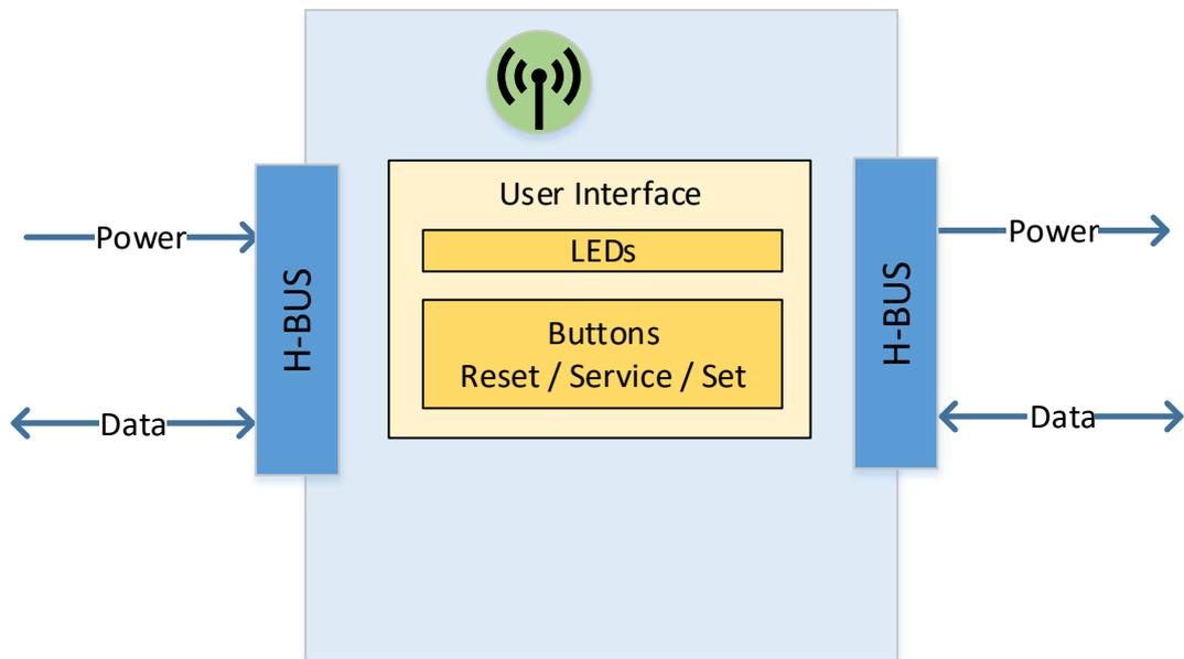
Abbildung 46: M2S Funk-Modul Blockdiagramm
