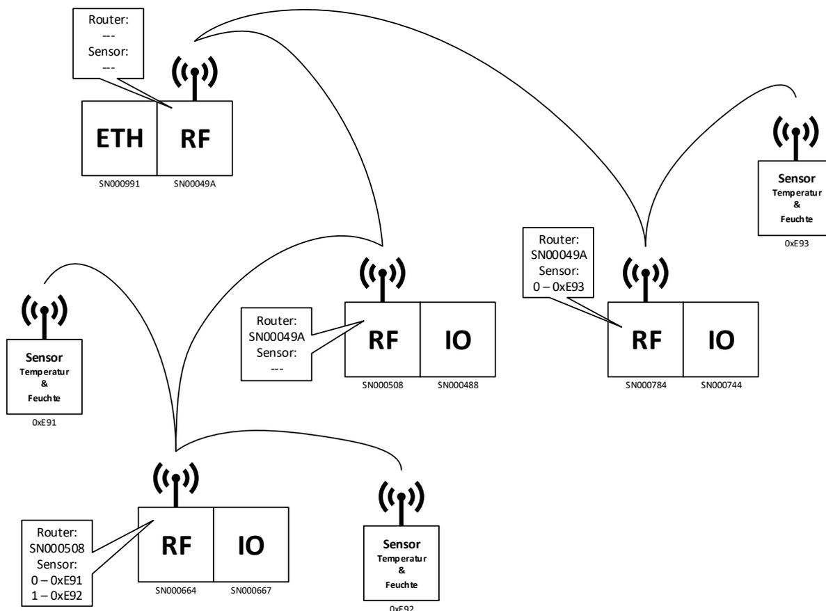
Abbildung 47: M2S Funk-Modul Topologie Beispiel
