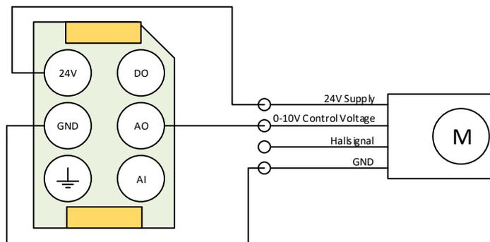
Abbildung 40: M2S I/O-Modul Anschlussbeispiel Ventilator mit einstellbarer Drehzahl
