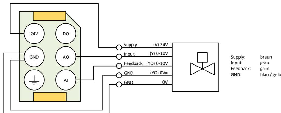
Abbildung 42: M2S I/O-Modul Anschlussbeispiel Ventil mit Positionsrückmeldung
